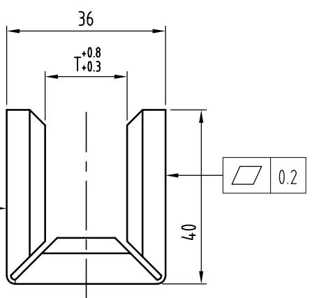
注：上图为安装后折弯图，检测折弯后尺寸时，需将靴衬安装至靴衬支架内，通过止通规检验尺寸  $T_{+0.3}^{+0.8}$ ；
