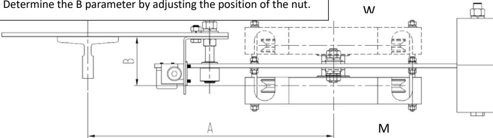
6. 将“安装板组件”贴紧导轨背面 (如上图) , 并用导轨夹使其固定在导轨上, 要求穿过钢丝绳后, 使涨紧装置尽量保持水平, 配重块的底面距离地面  $\geq 300$ mm;
