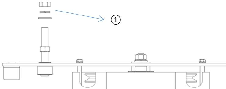
2. 按下图安装“安装板组件”，并将拆下的螺母，弹簧垫圈，平垫圈拧上；
