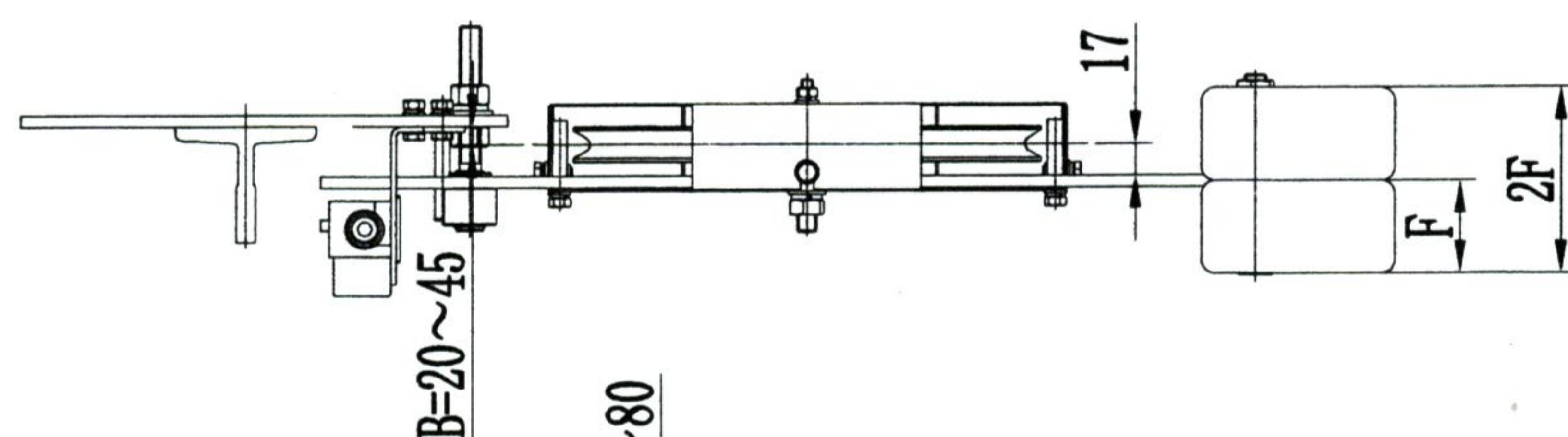
45&lt;B≤80时, 绳轮的安装方式
