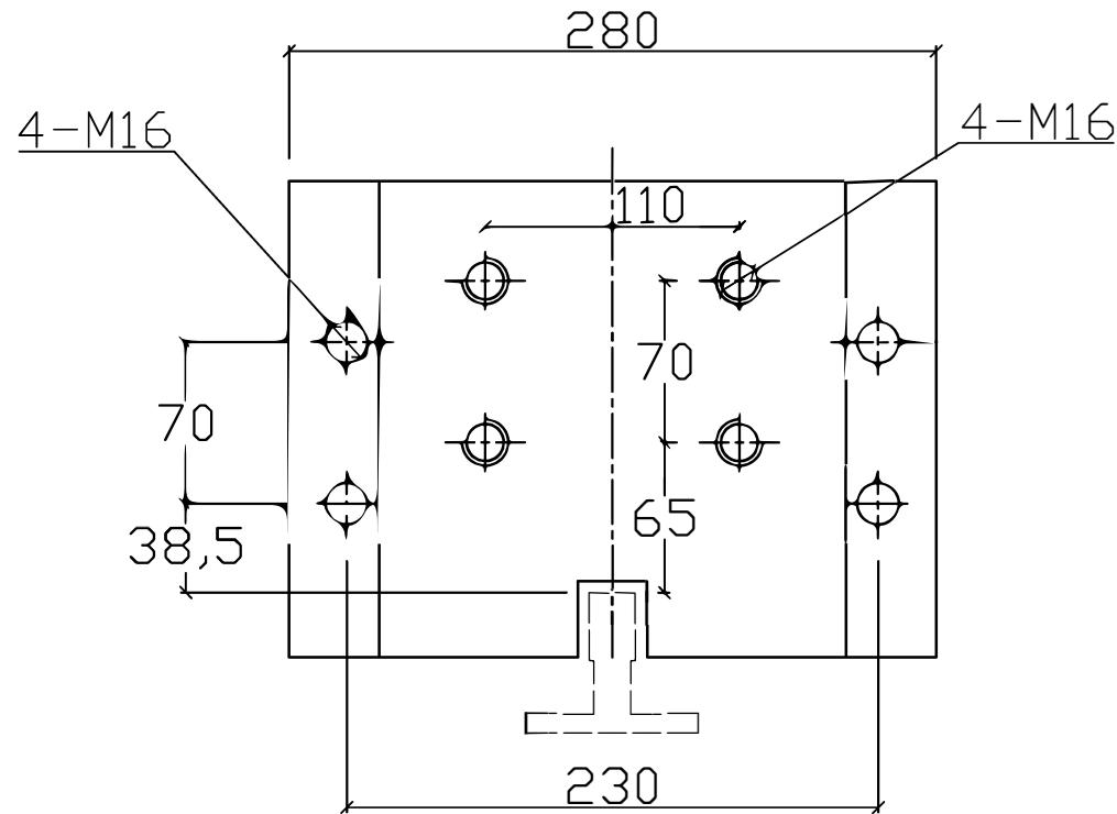
本图仅要求安全钳上板宽度、安全钳与下梁和导靴连接孔尺寸，其余不做要求，以供应商为准。
