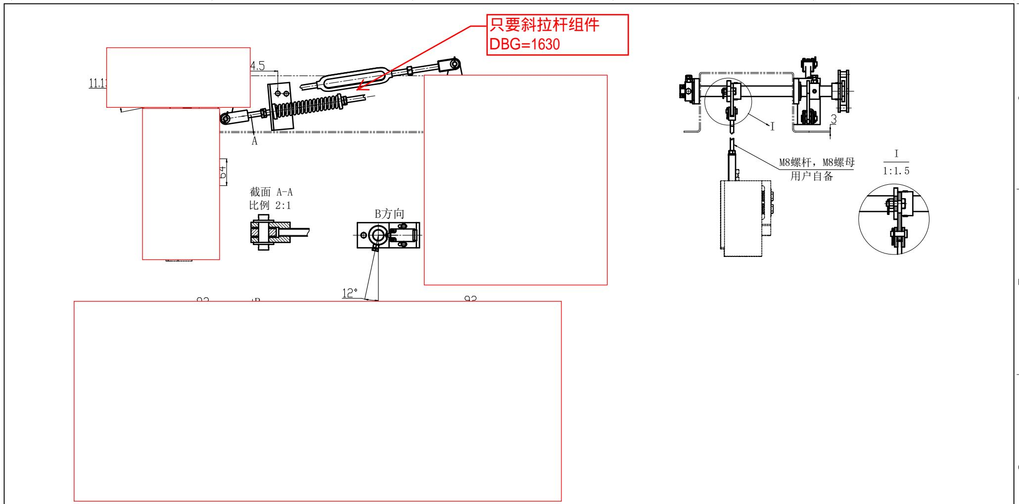
站在轿厢中心面对导轨，提拉位置在导轨右侧为右置，在导轨左侧为左置
