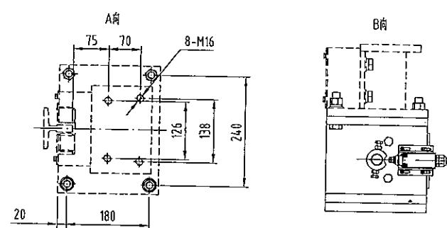
☆左提拉按图制作, 右提拉按图对称制作
