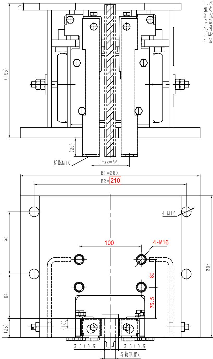
1. 本件适用额定速度：≤2.5m/s，允许系统质量（P+Q）需参照有效的型式试验报告；生产时需注明参数要求；
