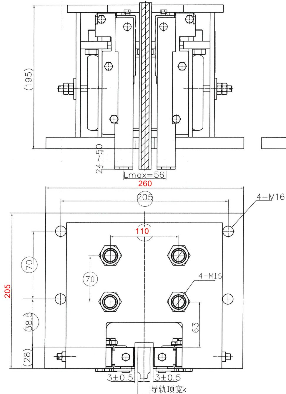
1. 本件适用额定速度:  $\leq 2.5 \text{ m/s}$ , 允许系统质量( $P+Q$ )需参照有效的型式试验报告; 生产时需注明参数要求;
