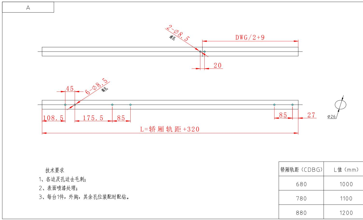
材质: 钢管Q235-A 此项目轿厢轨距: 580mm 设备号: D023365E 设计: 李维良 审核:
