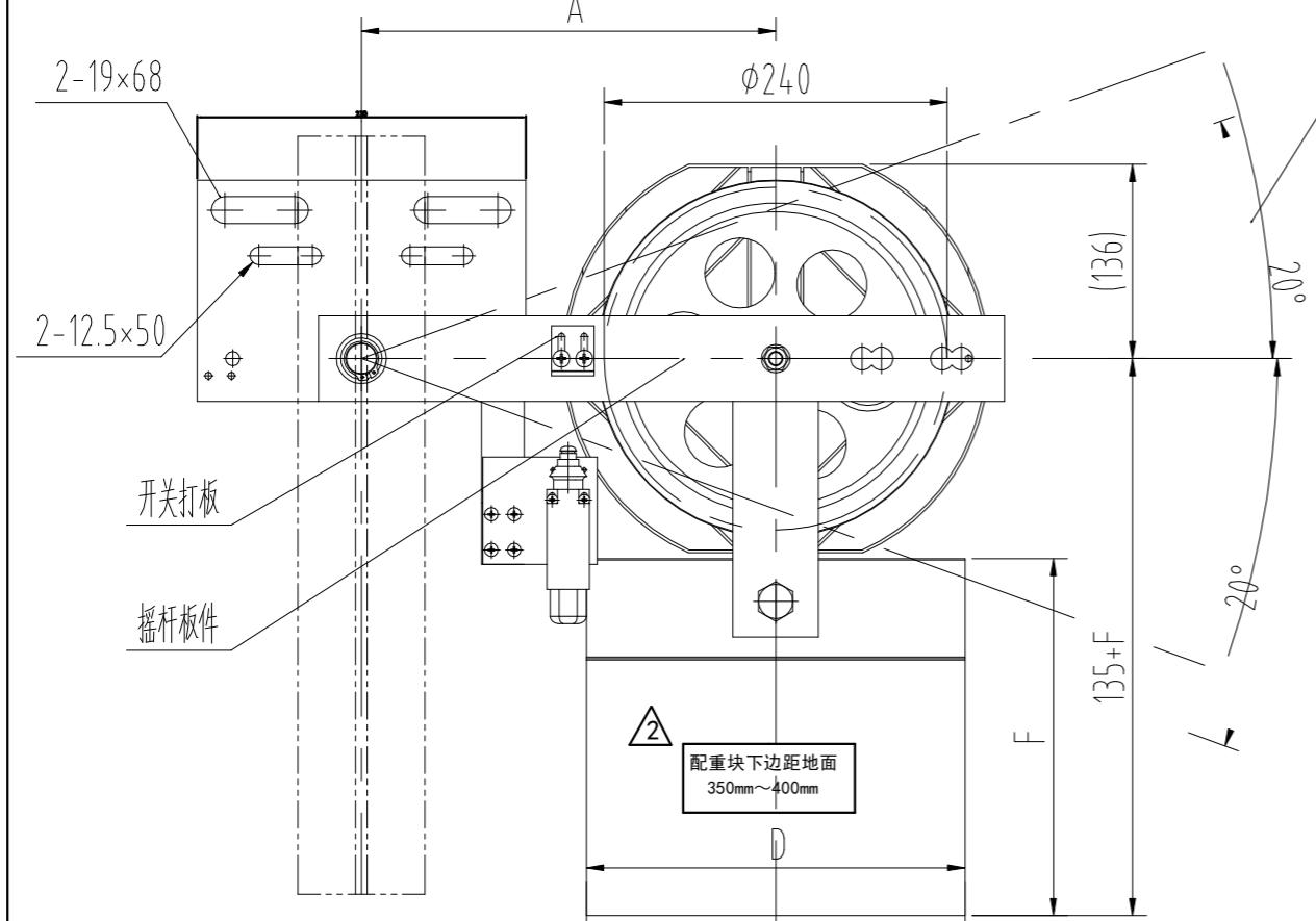
该摆角为极限参数，实际使用时可根据需求调整开关打板，
