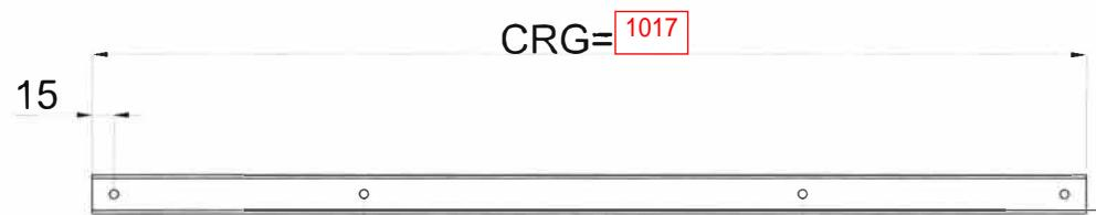
图中孔位在圆管外购回来后，装配安全钳提拉装置时配钻
