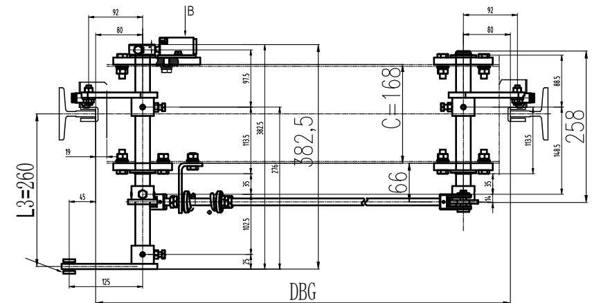
站在轿厢中心面对导轨, 提拉位置在导轨右侧为右置, 在导轨左侧为左置
