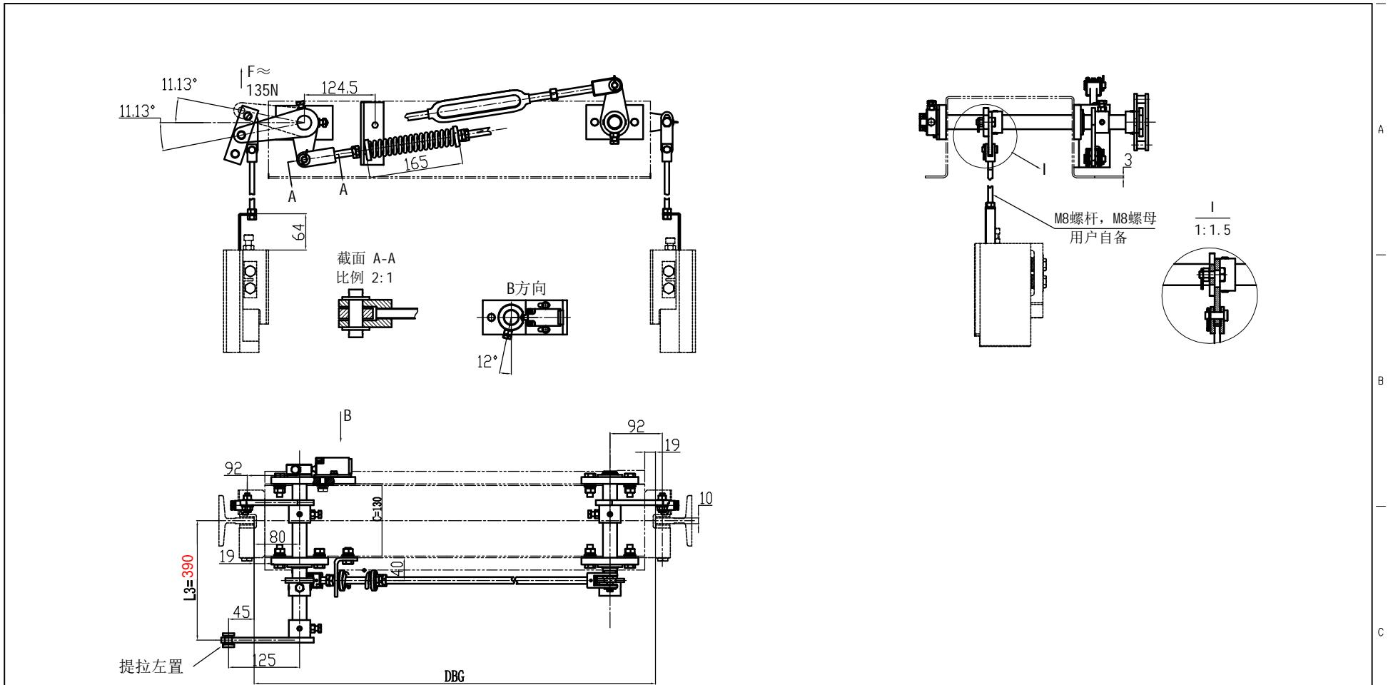
站在轿厢中心面对导轨，限速器钢丝绳提拉位置在导轨右侧为右置，在导轨左侧为左置
