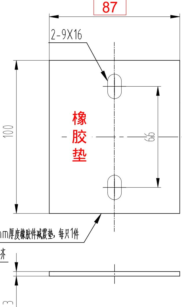
3mm厚橡胶件减震垫,每只1件
