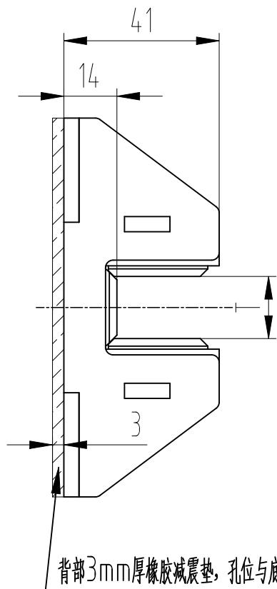
背部3mm厚橡胶件减震垫,孔位与底板对齐
