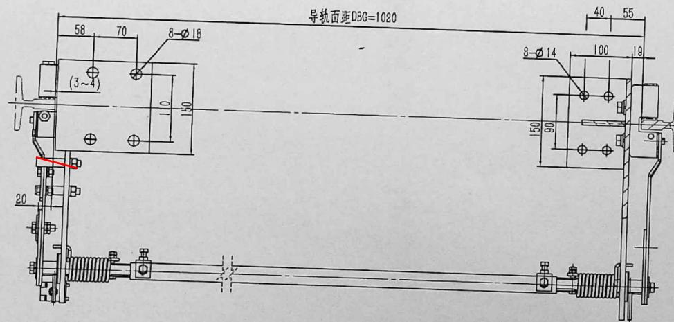
说明 本装置适用于调整各部件的相对位置，以保证各部件的正常工作。在调整时，应注意两侧安全销的同步状态，如不同步，则应重新调整，直至完成定位。
