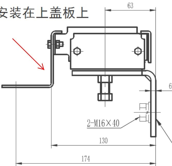
80007218 0X-029Y导靴(取消毛刷 增加支架 安装板更改 JJ30.01A)
