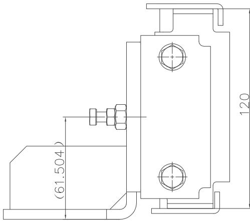
80007218 OX-029Y导靴(取消毛刷 增加支架 安装板更改 JJ30.01A)
