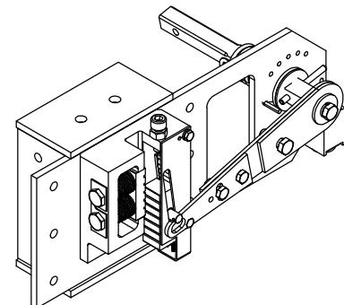
80006130 OX-210BZ安全钳联动机构(孔距70) 浅灰RAL7035 中英文 美嘉智选 P1-14
