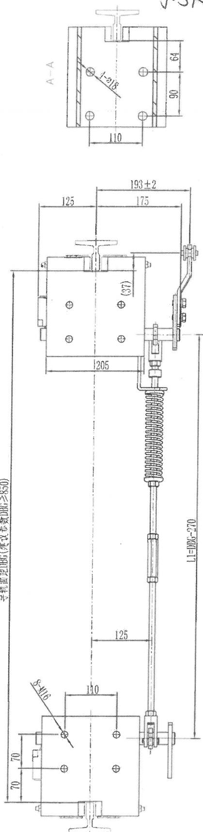
**80001770 OX-188DT安全联动装置（左置）DBG=2200 灰色RAL7037 全英文 怡达快速**
