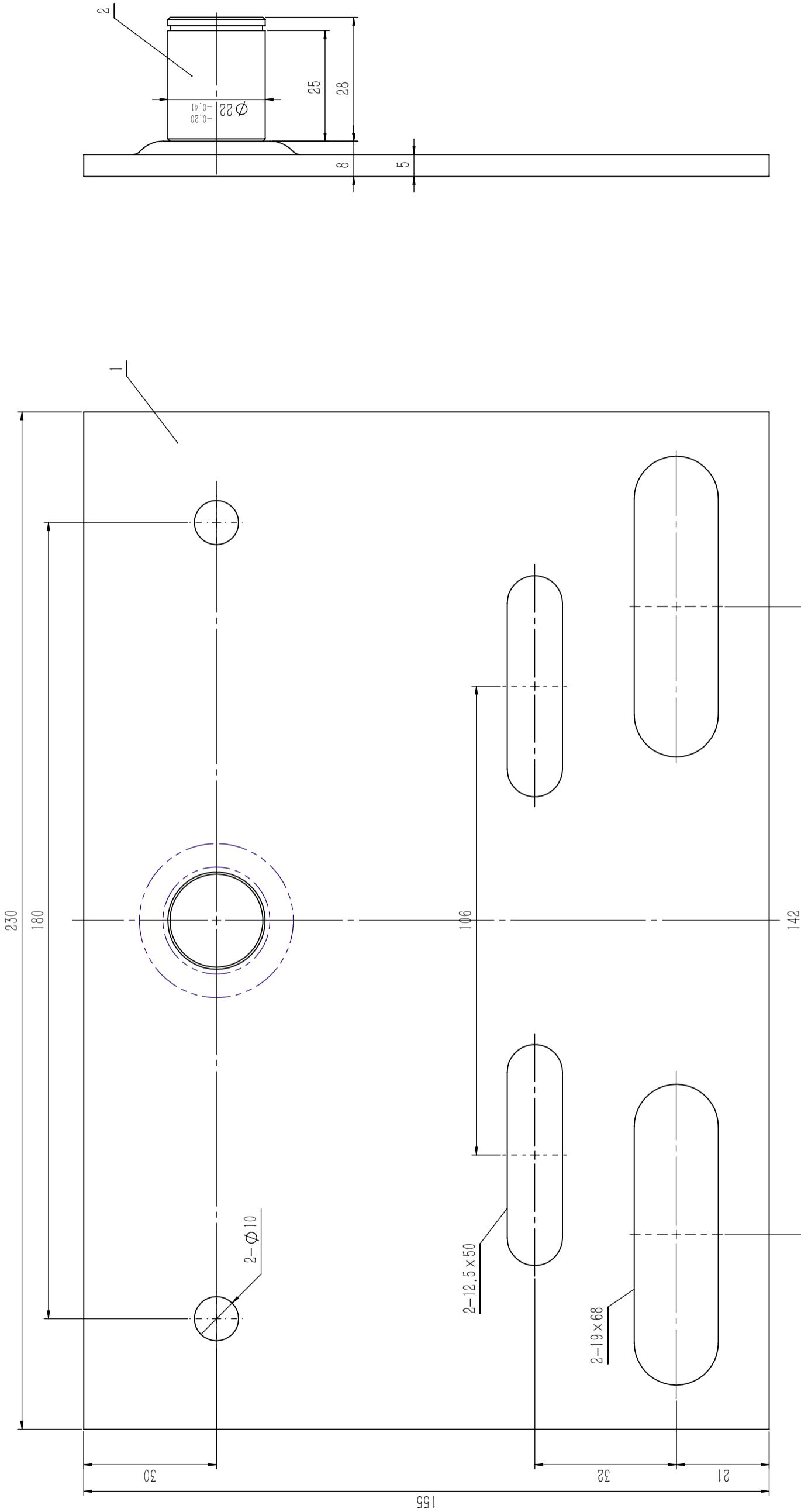
技术说明 1. 本件采用研磨形式装配时注意装配间隙，要求铆接牢固可靠，漆的防护，漆面颜色要符合图纸要求。2. 铆接接头处无划挂、撞击等痕迹，且无偏斜晃动等现象。
