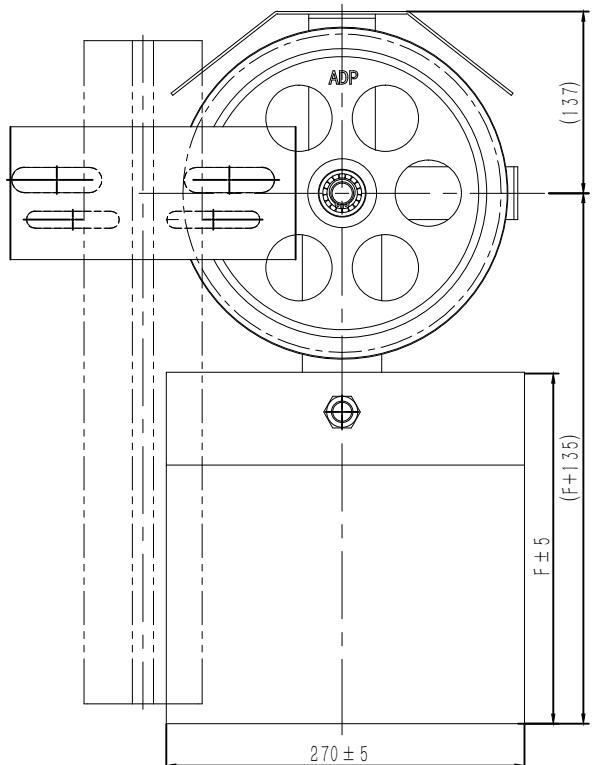
配M12×12的连接螺栓2套
