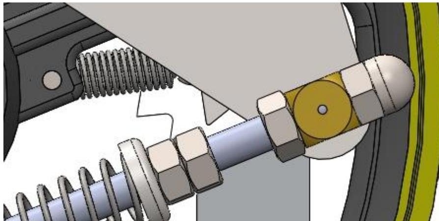
第二步，将手柄上的凹槽扣在挡绳杆上，并紧贴在机架板，如下图：
