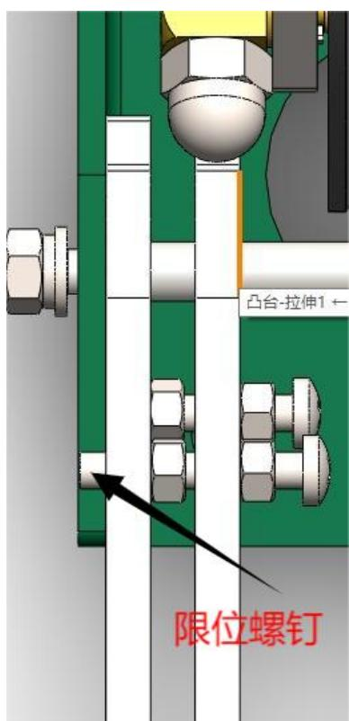
第三步，向上转动手柄使限速器工作时盖型螺母顶端不会碰到手柄导向面（大圆弧面）如下图：
